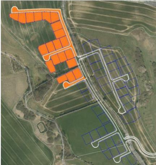
Bilag 2. Forslag til placering af bassinet og rørforingen i oplandet og udløbepunktet til Fredsted Bæk
